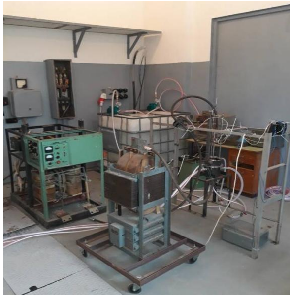
Zīm. 1.1. Ti/TiAl iekārtas reaktora modeļa stends metalurģiskajā boksā.
