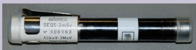
Individuālais dozimetrs. Rāda radioaktīvā starojuma dozu līdz diviem milizivertiem (mSv). Tas nav daudz, gadā mēs saņemam no vides aptuveni 3 mSv lielu dozu.
