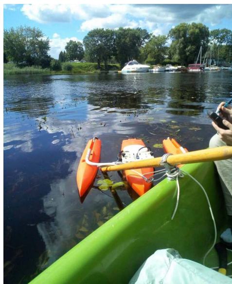
2. attēls. Lielupes profilēšana, stiprinot RiverRay iekārtu pie laivas, kura darbināta ar elektromotoru
