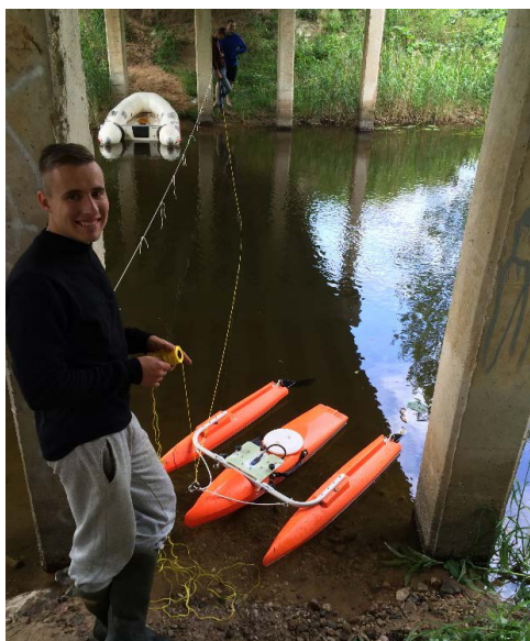
1. attēls. Engures profilēšana, izmantojot auklu RiverRay iekārtas pārvietošanai pētījuma vietā
