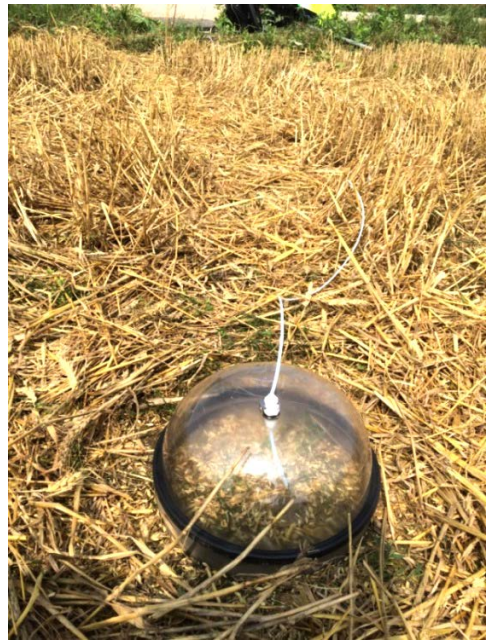
3. attēls. Kamera gāzu mērījumu veikšanai (autors: J. Pilecka)
