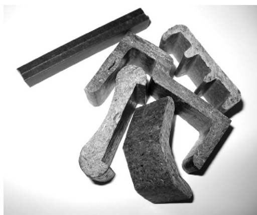
Zīmējums 4. Kompozītparaugi, kas ir pildīti ar amooksidētajām skaidu un mizu mikrodaļiņām
