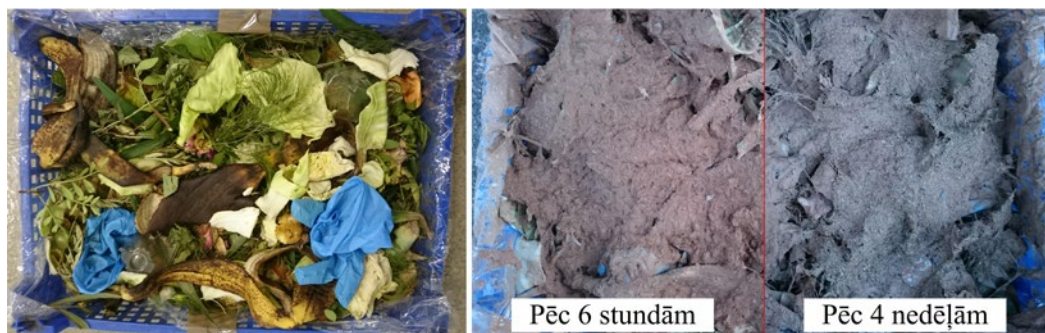
Zīmējums 2. Pa kreisi – atkritumi pārklājuma uzsmidzināšanai, pa labi – uzsmidzināts pārklājums
