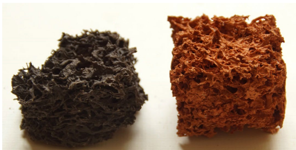
6. attēls. Slāpekļa vidē (pa kreisi) un gaisa atmosfērā (pa labi) saķepinēti paraugi, pielietojot par „veidni” ķērpī un Apriķu māla – ūdens suspensiju
