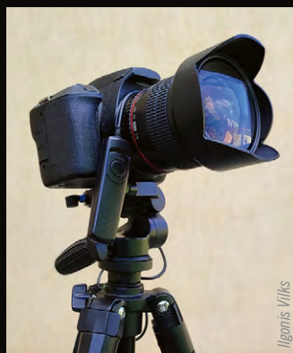
Spoguļkamera uz stabila statīva ar lielas gaismasspējas objektīvu. Redzams arī distances elektroniskais slēdzis
