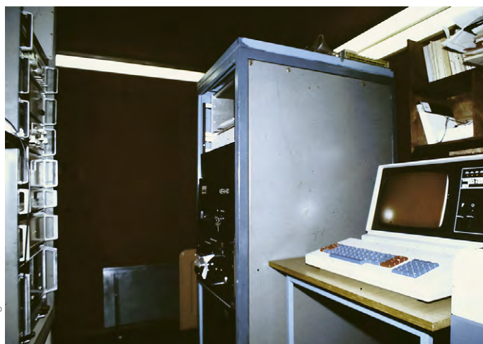
Aparatūra un skaitļotājs MERA-60 lāzera tālmēra LS-105 konteinerā
