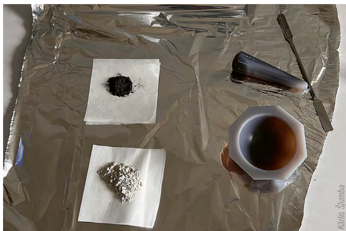
Olivīns (baltais) tiks sajaukts ar dzelzs sulfīdu (melnais), veidojot trojieša regolīta imitāciju
