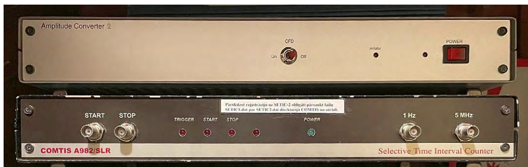
Elektronikas un skaitļošanas tehnikas institūtā izstrādātais notikumu taimeris COMTIS A982/SLR
