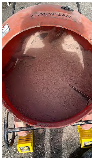
Regolīta imitācijas ražošana notiek betona maisītājā, to jaucot pat 24 stundas ilgi
