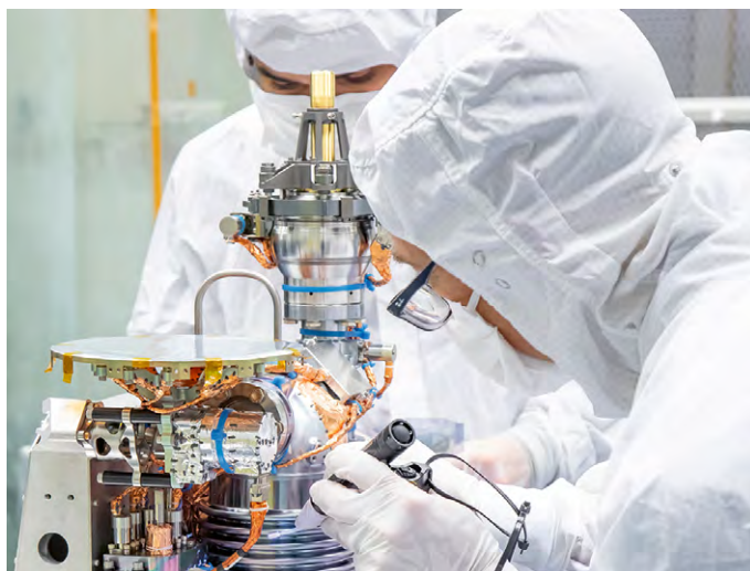
Topošās Jupitera zondes Europa Clipper masspektrometrs
