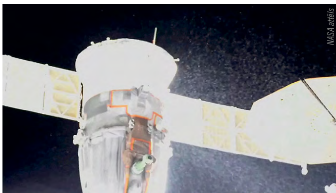
Dzesēšanas šķidrums noplūde no kosmosa kuģa Sojuz
