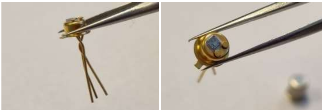
1.attēls. Izgatavotā mikrotriodes struktūra ar noņemto vāciņu.
