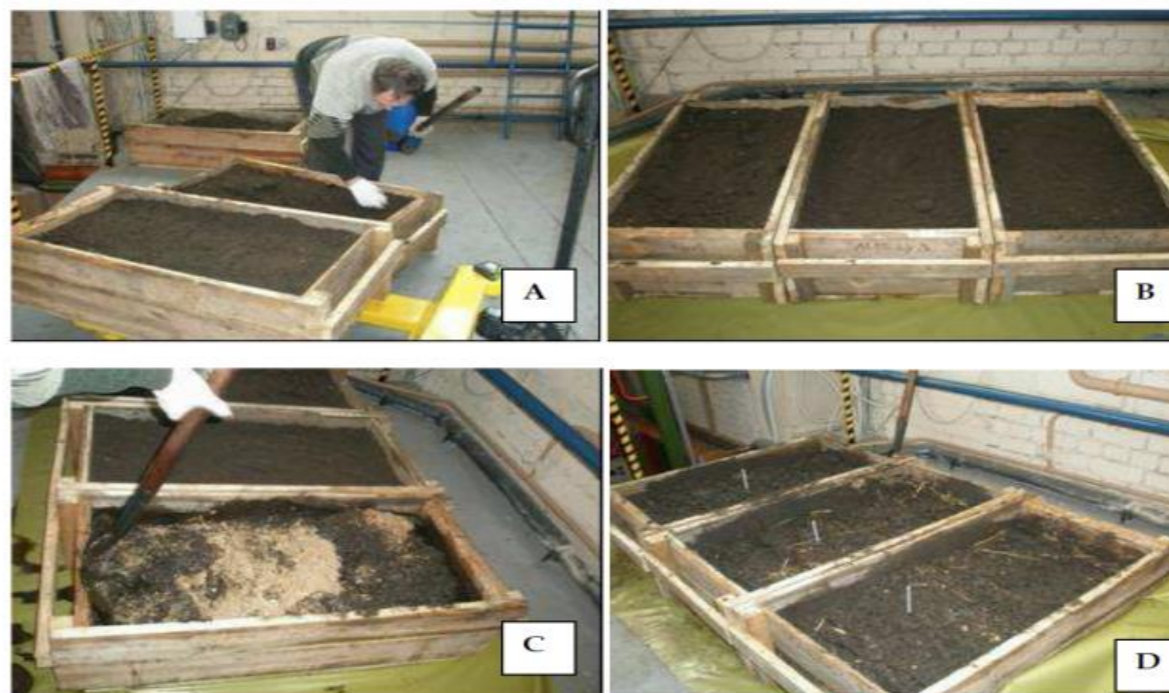
6.1.att. Eksperimenta sākums. Trīs variantu veidošana, t.i. grunts; grunts ar skaidām; grunts ar salmiem. A, B, C, D – grunts variantu veidošanas secība.
